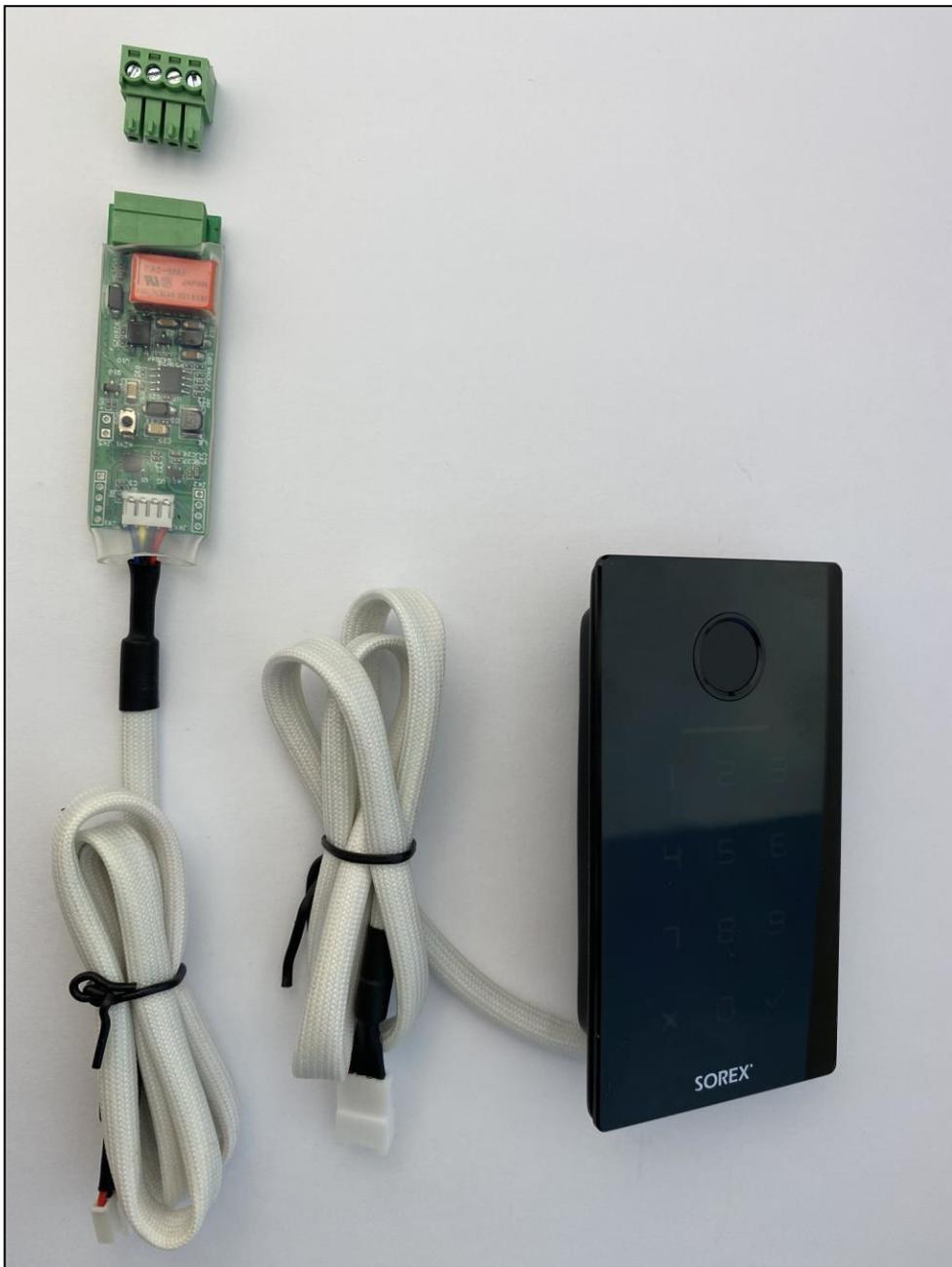
1. Unilock Inneneinheit inkl. Kabel zur Verbindung mit Außeneinheit
